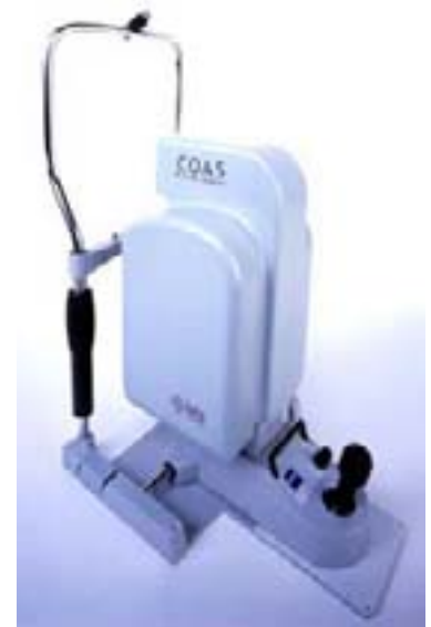
شکل ۷- تصویر اعوجاج سنج مدرن چشمی Shack-hartmann
