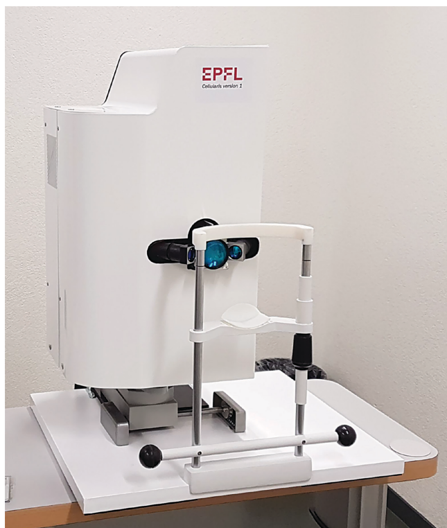
دستگاه سلولاریس؛ نمونه اولیه برای تشخیص بیماری‌های دژنراتیو چشمی پیش از بروز علائم
