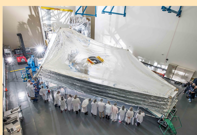
تصویر ۲. واحد آزمایش سپر خورشیدی در تاسیسات Northrop Grumman در کالیفرنیا، ۲۰۱۴.
